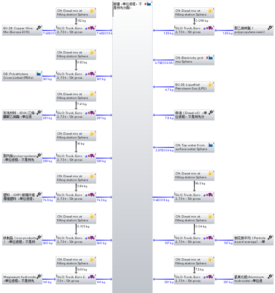
图 5.1 生产 1 千米 WDZ-YJY-4×185+1×95 电力电缆生命周期评价 Gabi 总模型
